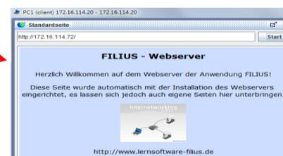
Observer les échanges entre le PC1 client et le PC3 serveur http en cliquant droit sur le PC1 et en sélectionnant « **show data exchange** » : → Protocoles ARP, HTTP, TCP, IP (voir annexe 2 pour les résultats)
